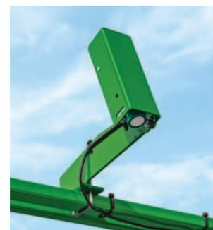
**Le système « BoomTrac »** améliore la précision et la répartition de l'application et réduit la dérive, en contrôlant automatiquement au travail l'inclinaison et la hauteur de la rampe. Il est très utile sur terrains irréguliers, ainsi que lors des manœuvres en bout de champ.
