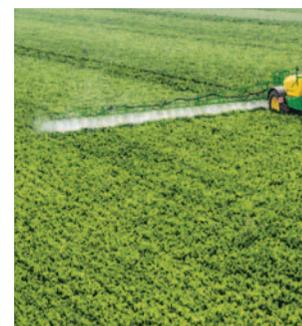
**Le Contrôle de Sections John Deere**, disponible sur les modèles M700 et M700i, diminue le coût des intrants en limitant significativement les manques et les recroisements. Ce système basé sur un positionnement d'GPS ouvre et ferme automatiquement les sections de rampe lorsque vous quittez ou traversez une zone prédéfinie.
