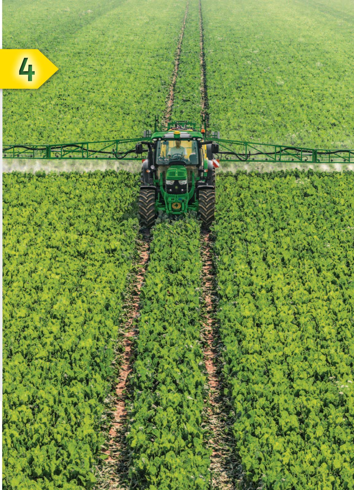
**Suspension de rampe avec système anti-fouettement indépendant**
