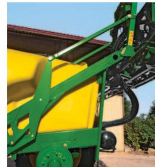
**La conception robuste du parallélogramme** garantit l'homogénéité de la vitesse de réglage de la hauteur de la rampe et de la garde au sol arrière.
