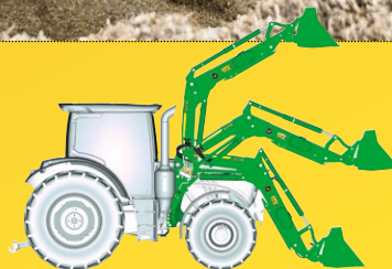
Parallélogramme de mise à niveau mécanique (MSL) Adapté à tous types de travaux lourds
